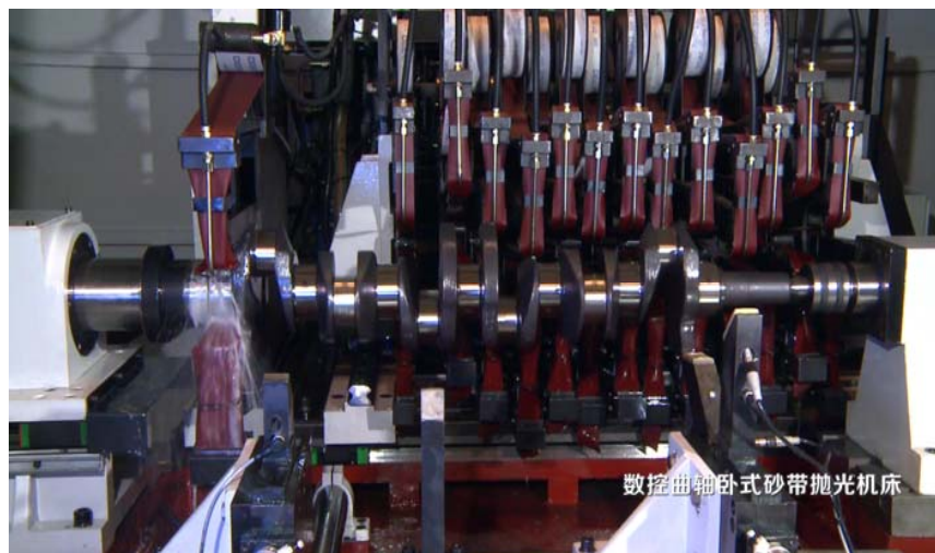
PQZ1200 全自动卧式抛光机床——工作状态
